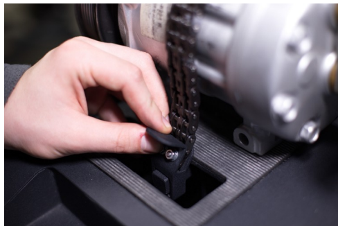
Рисунок 23. Установка компрессора на стенд и его фиксация
