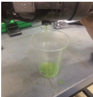
Рисунок 21. Контроль состояния масла компрессора
