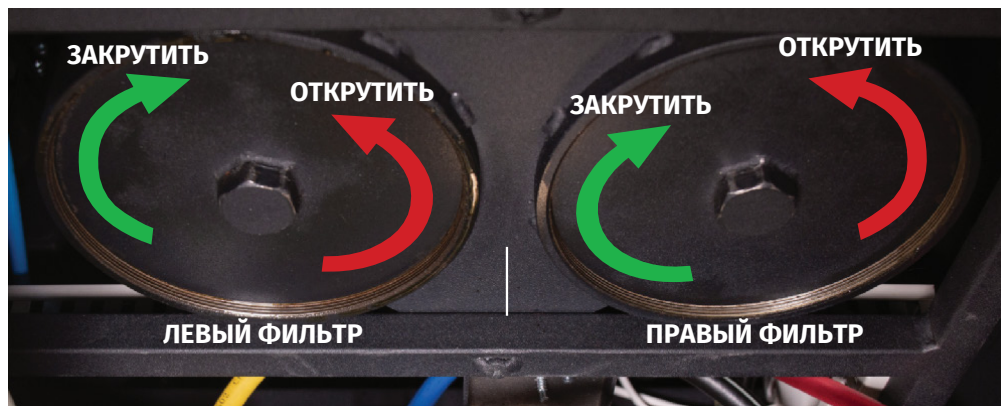
Рисунок 37. Направление вращения крышки при замене фильтров MS0101
