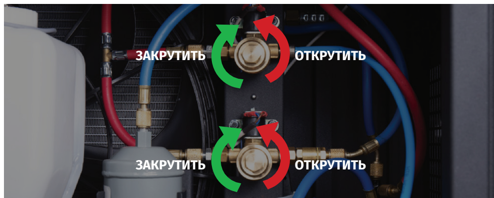
Рисунок 41. Направление вращения крышки при замене фильтров MS0102
