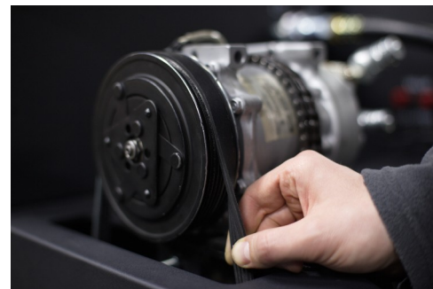
Рисунок 24. Установка ремня и проверка степени его натяжения
